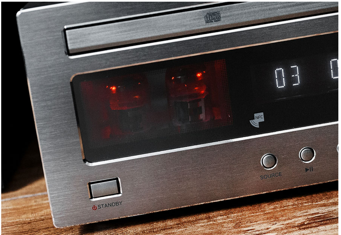
兩支真空管可以直接見到，有前面板保護，開機時需要大約 20 秒預熱。
